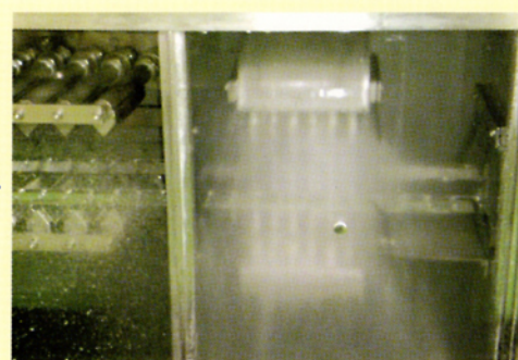
高圧揺動シャワー洗浄
