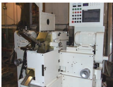
ワーク搬入・搬出シュート部
