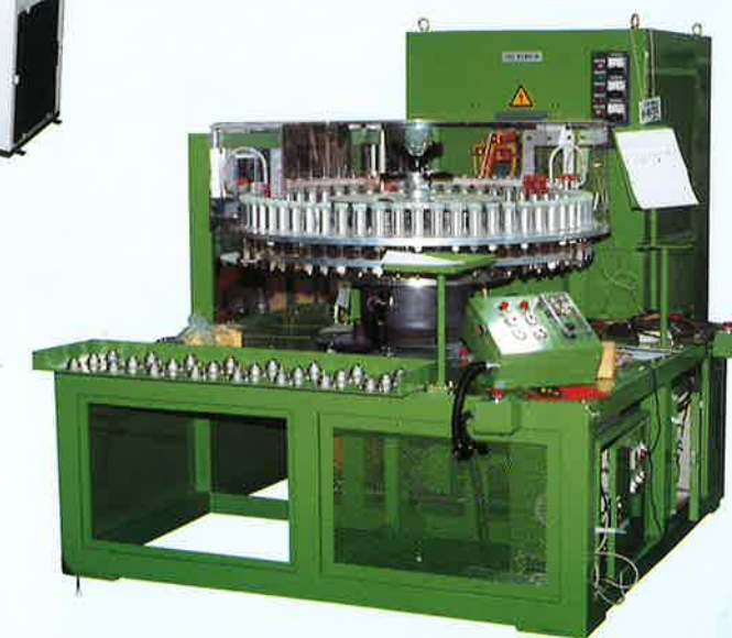
ロータリー式 接着剤硬化用加熱装置
