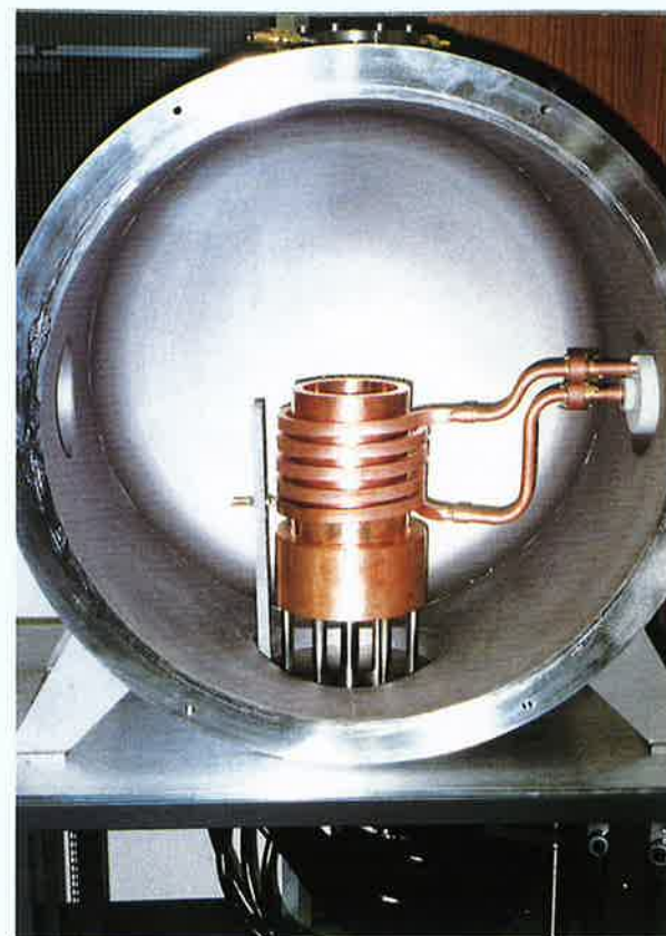
コールドクルーシブル スカル溶解炉 溶解量 10kg
